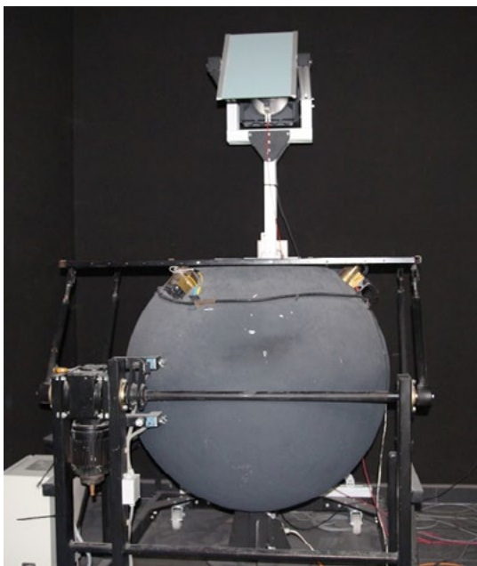
Rys. 1 Spektrofotometr ze zintegrowaną sferą Ulbricht'a (średnica 1m)
